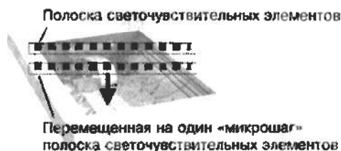
Рис. 1.2. Оптическое и аппаратное разрешение сканера
