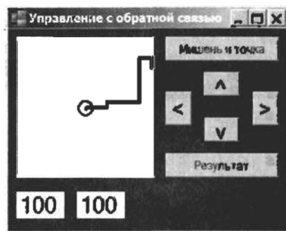
Рис. 5.4.2. Модель системы управления с обратной связью
